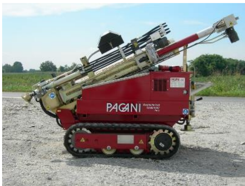
Slika 4: Dinamični penetrometer Pagani TG 63-100
